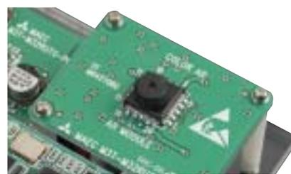
写真3: 人工網膜カメラ
