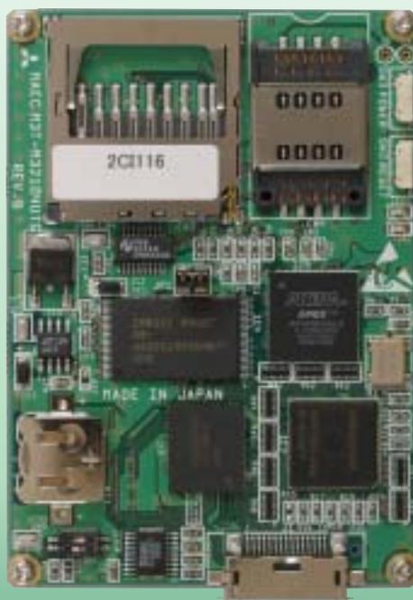
$\mu$ T-Engine/M32104開発キットのCPUボード(原寸大)
