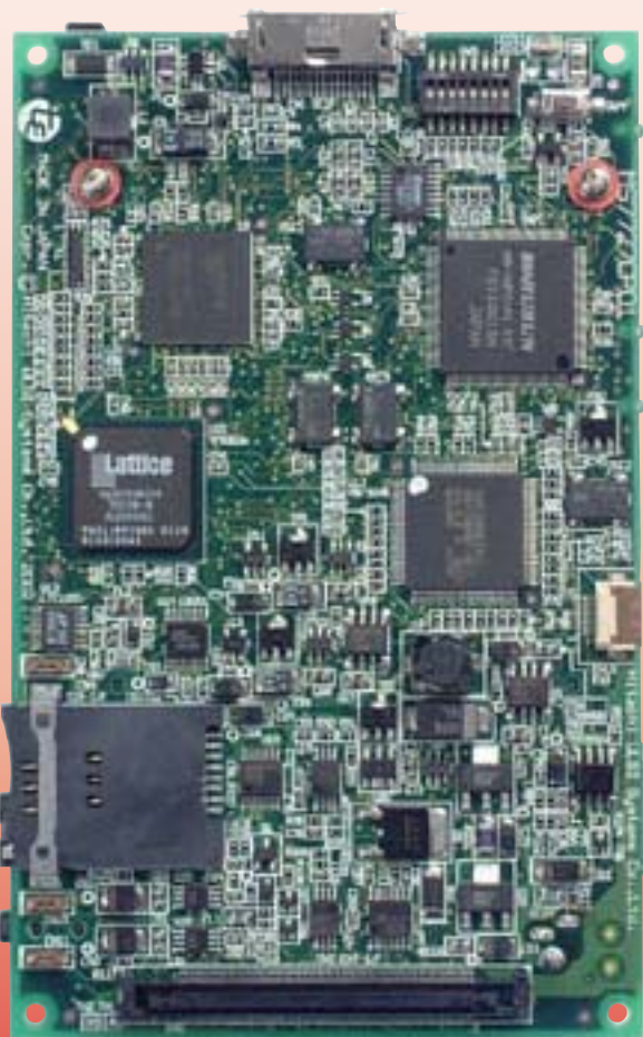
SH7727を搭載した標準T-Engine仕様のCPUボード(原寸大)
